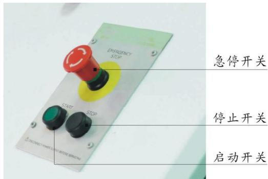
图 4-2: 停止、急停及启动按钮图
