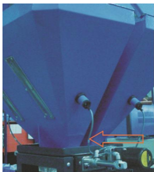
图 4-27: 料斗上的料位开关图
