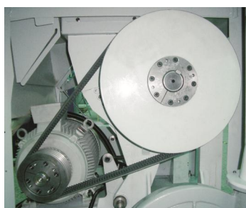
图 3-8：皮带轮及电机的安装五
