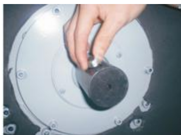
图 3-4：皮带轮及电机的安装一
