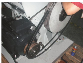
图 3-6：皮带轮及电机的安装三
