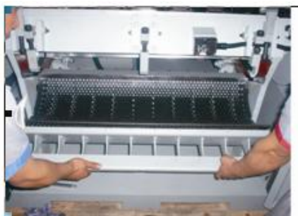
图 3-10：筛网架与筛网的安装
