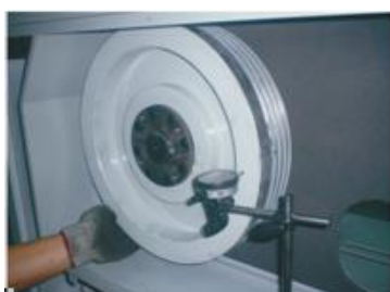
图 3-5：皮带轮及电机的安装二
