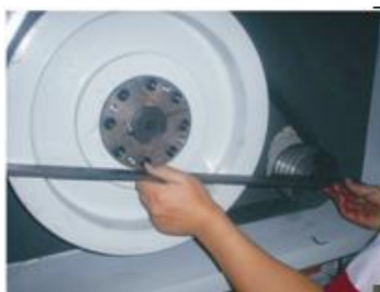
图 3-7：皮带轮及电机的安装四
