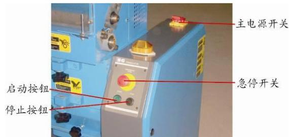
图 4-7: 停止及启动按钮、急停开关
