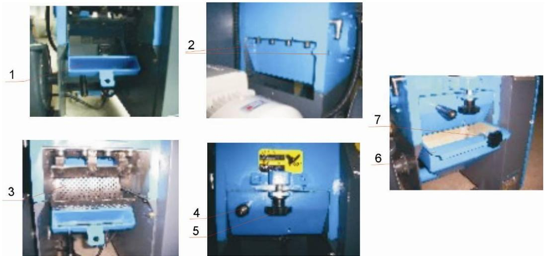
图 3-12: 筛网架、筛网与集料盒的安装
