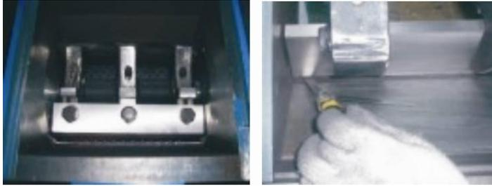
图 3-3: 动刀与定刀的安装
