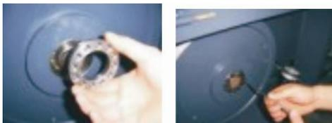
图 3-6: 皮带轮及电机的安装三
