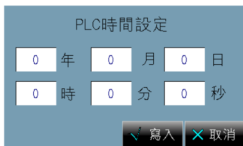
图 4-14: PLC 时间设定画面
