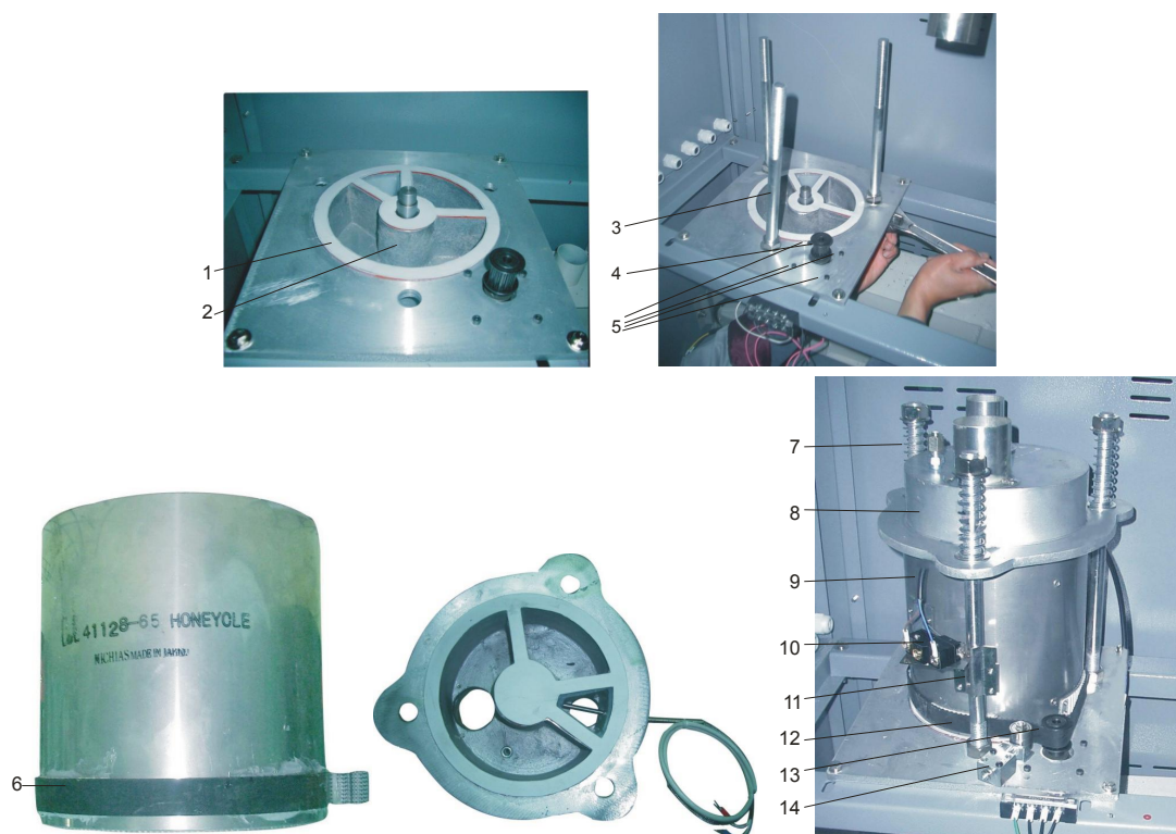
图 6-3: 蜂巢转轮安装示意图
