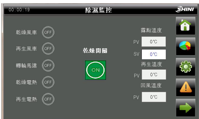
图 4-15: 除湿监控画面
