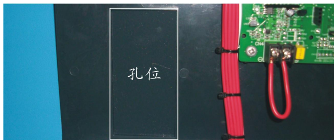
图 6-5: 露点计安装孔位
