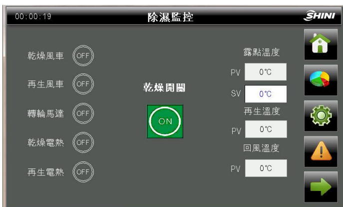
图 4-15: 除湿监控画面
