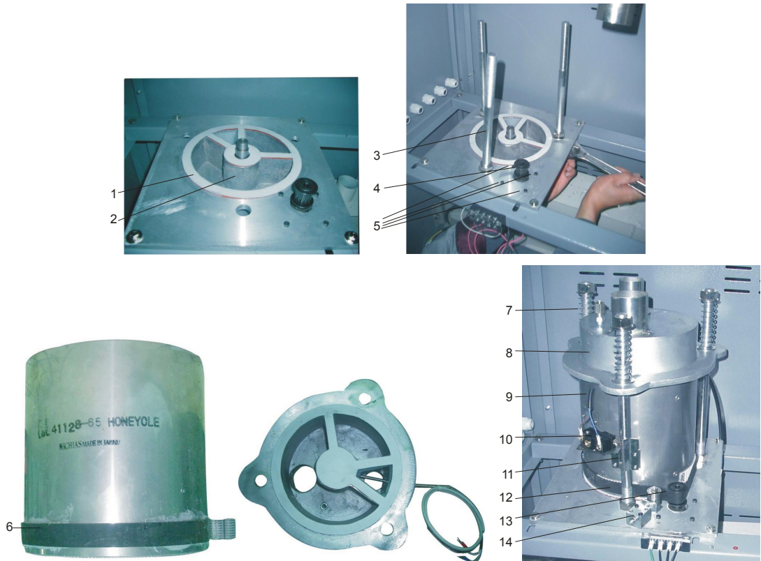
图 6-7: 蜂巢转轮安装示意图
