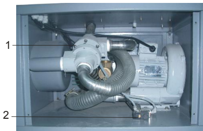
图 6-4: 吸料风机安装图
