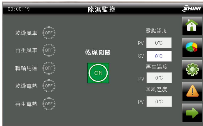
图 4-4：除湿监控画面
