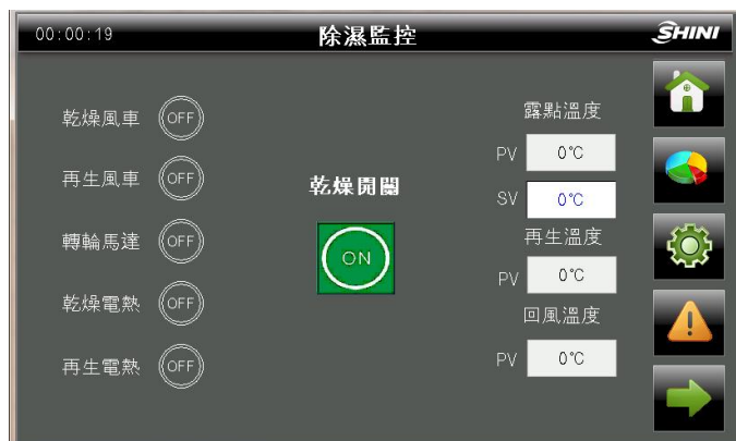
图 4-12: 除湿监控画面
