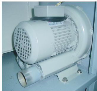
图 6-3: 干燥风机安装图
