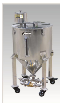
光学级储料桶( 5\mu\text{m} )
