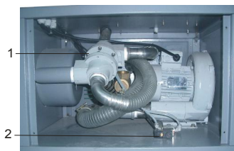
图 6-4: 吸料风机安装图
