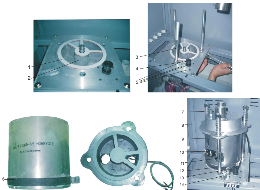
图 6-7：蜂巢转轮安装示意图
