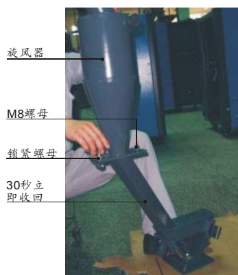
图 3-6: 30 秒立即回收系统安装图三
